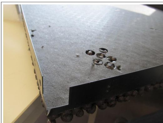
spouwzijde paneel (met enkele vrijgemaakte perforatie gaten)
